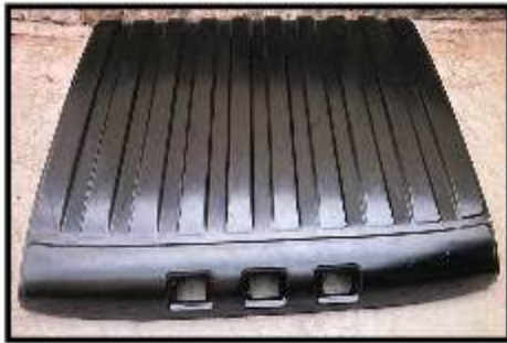
車頂蓋 Roof panel
