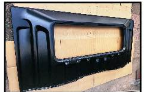
後牆 外 Back wall outer
