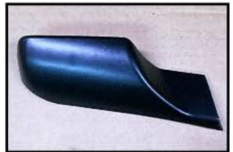
車門後鈕 外蓋/靠前柱 左 Front pillar cover
