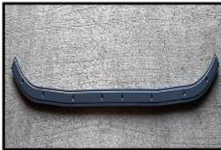
保險桿內鐵 下橫梁 Bumper inner iron
