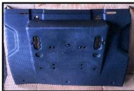
後輪檔泥板 前 Rear fender
