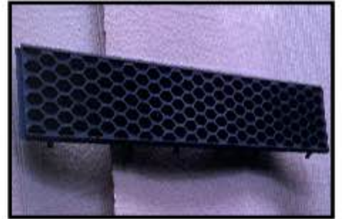
下巴通風網 中段/低 中 Bumper jaw cover
