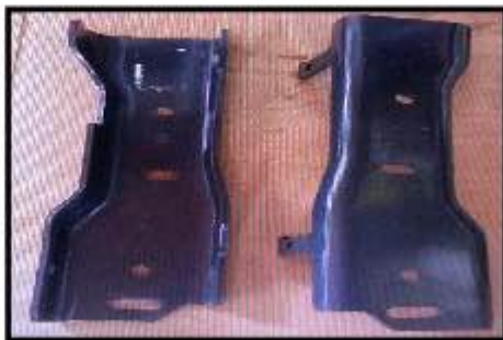
保險桿支架/側內鐵 左 Bumper bracket
