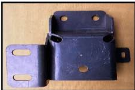
保險桿支架 固定座 右 Bumper bracket base
