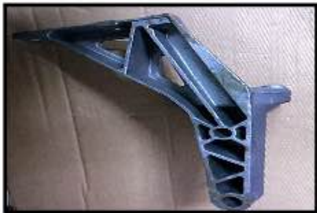
保險桿支架 鋁 左 Bumper bracket aluminum
