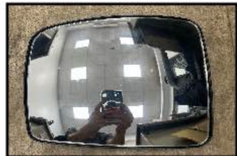
輔助鏡片 右 Auxiliary lens
