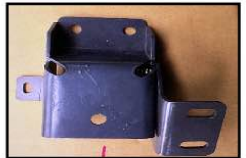
保險桿支架 固定座 左 Bumper bracket base
