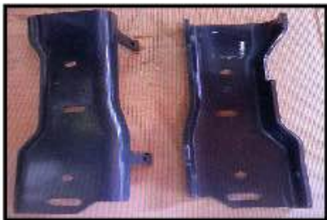
保險桿支架/側內鐵 右 Bumper bracket
