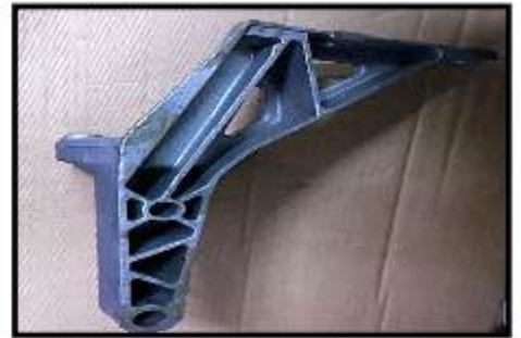
保險桿支架 鋁 右 Bumper bracket aluminum
