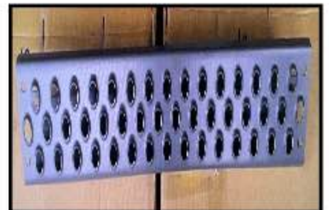
保險桿 踏板 中/鐵 Bumper pedal
