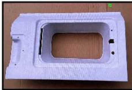
邊肚板 下段 左 Rear pillar base
