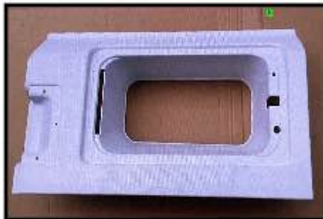
邊肚板 下段 左 Rear pillar base
