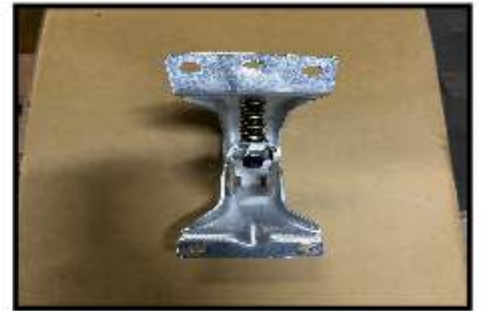
後輪檔泥板 固定座 後 Rear fender bracket
