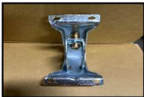
後輪檔泥板 固定座 前 Rear fender bracket
