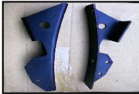
前輪後檔泥板 支架 左 Fender bracket
