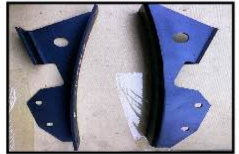
前輪後檔泥板 支架 右 Fender bracket
