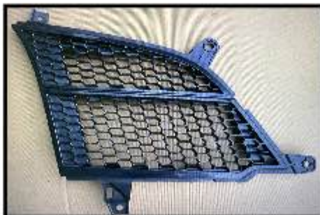
面板 通風網 右 Panel ventilation mesh
